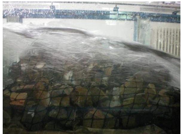
Figure 8 et 9 : Test en laboratoire des gabions tubulaires remplis de pierres : installation et mise en charge
