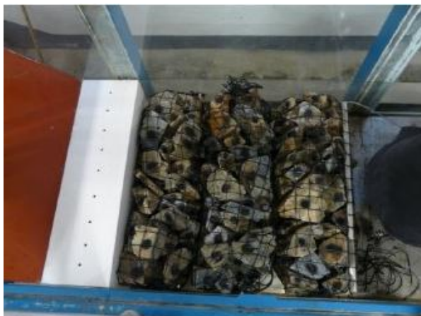
Figure 8 et 9 : Test en laboratoire des gabions tubulaires remplis de pierres : installation et mise en charge
